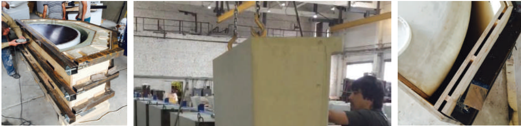
02 Изливање модела од течне гуме. Оплата.
